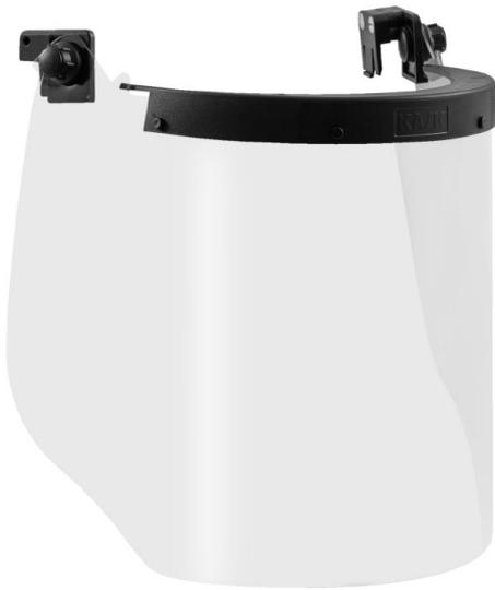
Ergonomischer Vollgesichtsschutz mit leichtem und kompaktem Design, der es dem Träger ermöglicht, an stromführenden Teilen zu arbeiten oder sich in deren Nähe aufzuhalten, mit Störlichtbogenschutz der Klasse 1 (GS-ET-29). Empfohlen für die Verwendung mit einer Sturmhaube. Lässt sich sicher auf- und abklappen. Wird direkt an den 30 mm EURO-Schlitzen befestigt.
