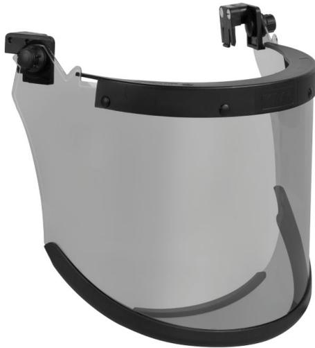
Protezione integrale ergonomica, dal design leggero e compatto, che consente di lavorare su o in prossimità di parti elettriche sotto tensione, con protezione dall'arco elettrico di Classe 2 (GS-ET-29). Consigliato per l'uso con il passamontagna. Si ribalta in modo sicuro verso l'alto e verso il basso. Si attacca direttamente alle fessure EURO da 30 mm.
