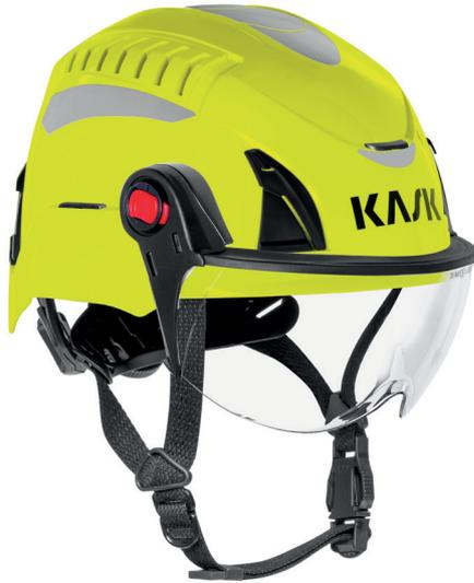
Protection des yeux en polycarbonate résistant au feu, aux rayures et à la buée. Nécessite les adaptateurs KASK Easy Click FR. Peut être porté avec des lunettes de correction. Compatible avec tous les casques Quantum. Conforme à la norme EN 14458.
