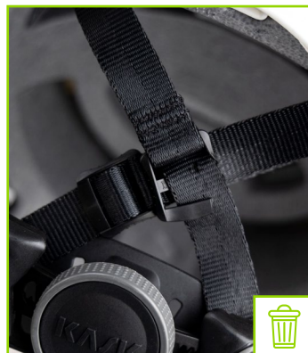
Hebilla de ajuste trasera rota
