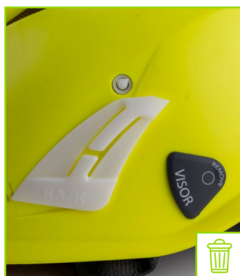
Clip para uso de linternas desprendido
