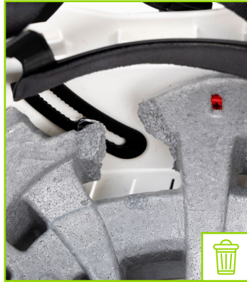
Carcasa interior con pieza faltante
