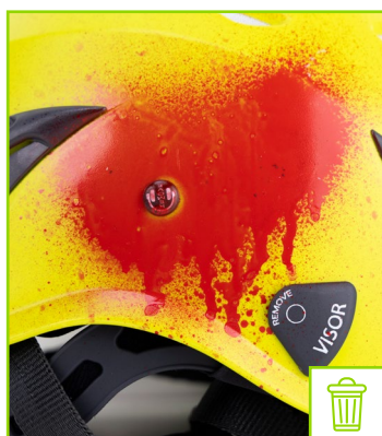
Carcasa con presencia de pintura
