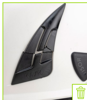
Clip para uso de linternas roto
