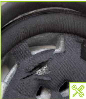
Acolchado interno agrietado
