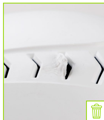
Carcasa con orificio de ventilación deformado
