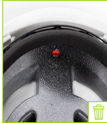
Carcasa interior con marcas de quemaduras de llama
