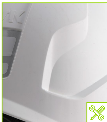
Clip para uso de linternas faltante
